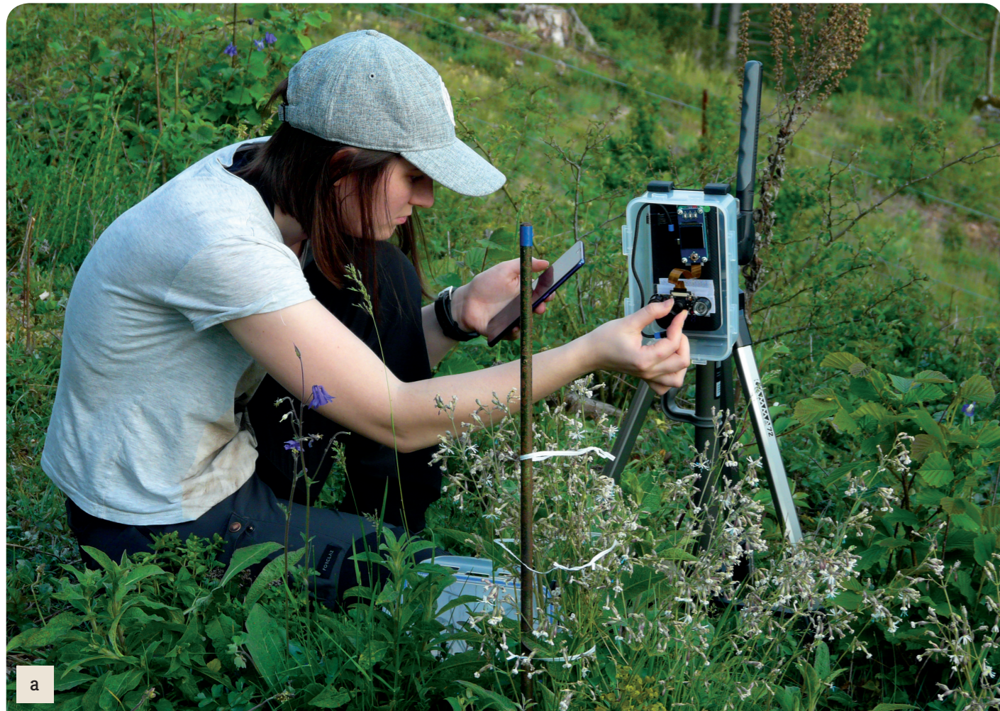
Figure 2a – Installation d'une caméra infrarouge faite maison à partir d'un micro-ordinateur (Raspberry Pi) dans la population de silène penché ( S. nutans ) à Coisse pour filmer les pollinisateurs nocturnes © Fabienne Van Rossum
